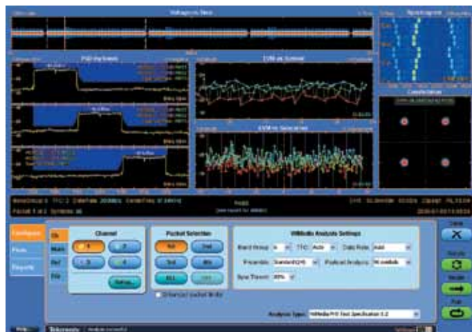
Сигналы WiMedia легко создаются с помощью генератора AWG7000 и ПО RFXpress.
