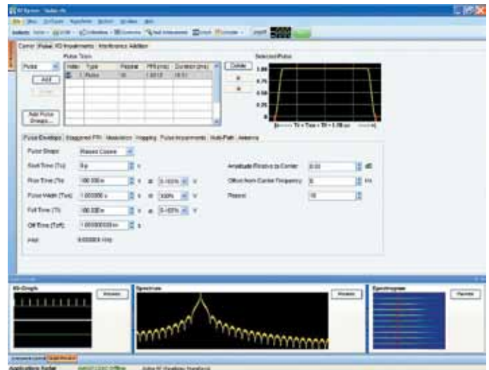
Радиолокационные импульсы, созданные с помощью генератора серии AWG7000 и ПО RFXpress.
